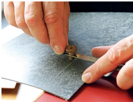
Der Anreißer für Hartbeläge verfügt über eine verstellbare Anreißnadel – für die Verlegung von Linoleum ein unverzichtbares Werkzeug.
